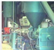
Extrudeuse de plastique (fonctionnant à l'électricité) pour fabriquer le tube dentifrice.
