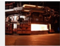
Four à silicium (fonctionne à l'électricité) pour faire le silicium des composants électroniques, mais aussi des silicones.
