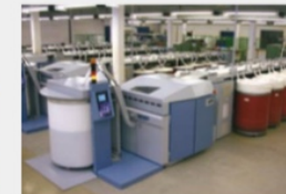
Peigneuse à laine (fonctionne à l'électricité).
