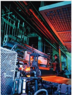
Train de coulage de verre (fonctionnant au gaz et à l'électricité) pour faire la glace.
